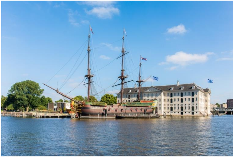
Afb. 2. Stichting Amsterdam Bouwt Oostindiëvaarder, Amsterdam , 1985, replica van een VOC-spiegelretourschip van irokoehout, 90,5 x 11,5 x 56 m., Het Scheepvaartmuseum, Amsterdam (afbeelding: https://www.hetscheepvaartmuseum.nl/over-ons/nieuws/2287/het-scheepvaartmuseum-opent-1-juni-zijn-deuren , geraadpleegd 19 januari 2024). Deze afbeelding dient als een illustratie van hoe een spiegelretourschip eruitzag.
